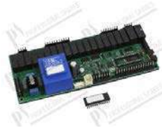
Motherboard dim. 225x100 mm
